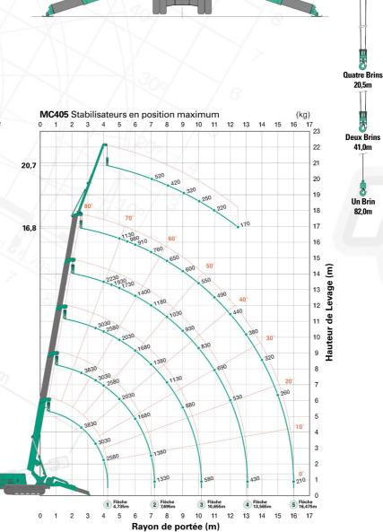
Le diagramme de portée montre la charge nominale totale, déformation de la flèche et bras pendulaire incluse.
