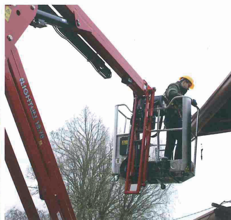
Nouveau panier avec angle pour une meilleure approche. Nieuwe hoekige werkbak, voor een beter bereik naar de muur.
