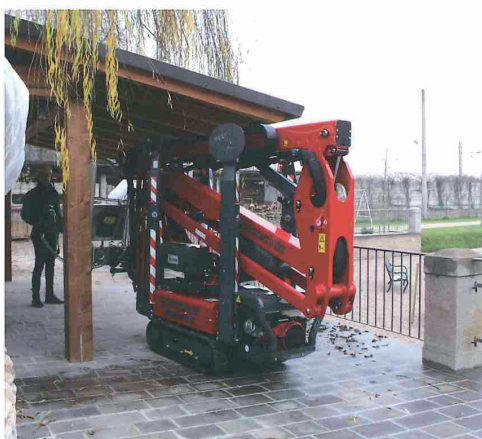
Dimensions très compactes, seulement 328 cm sans panier. Ultra compacte afmetingen, 328 cm kleinere werkbak.
